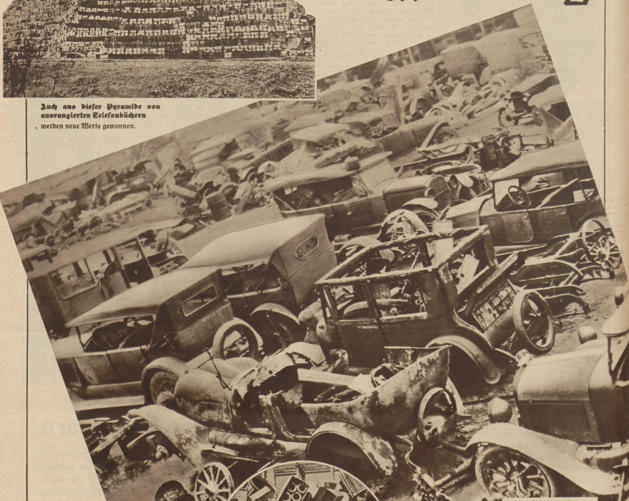
In den Autoschlätereien werden aus betriebsunfähigen Wagenwrads alle noch wertvollen Bestandteile herausgelöst und von neuem nutzbar gemacht oder verschrottet.
