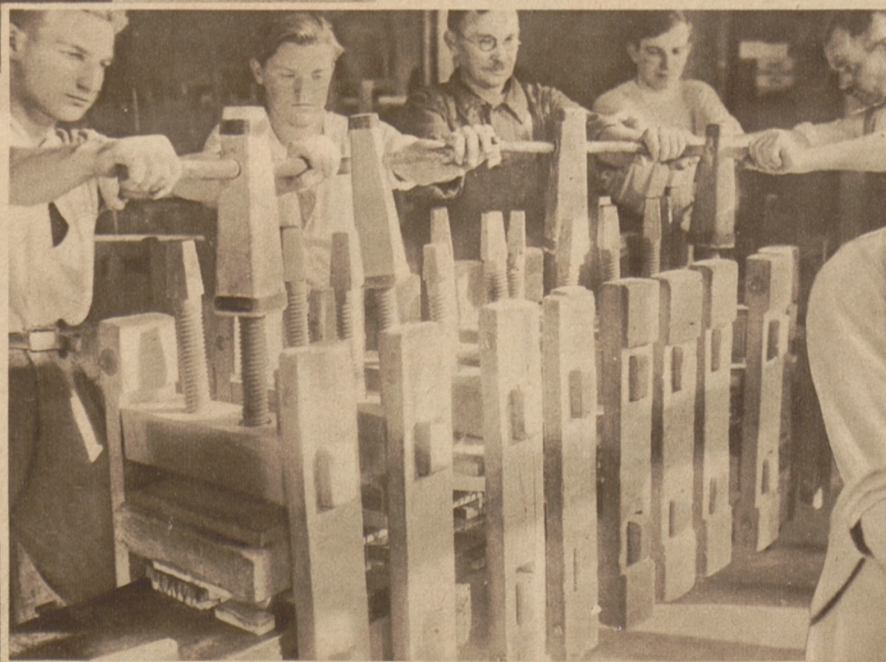
Die einzelnen Propellerteile werden unter Preßdruck in einen festen Block aneinandergeleimt.
