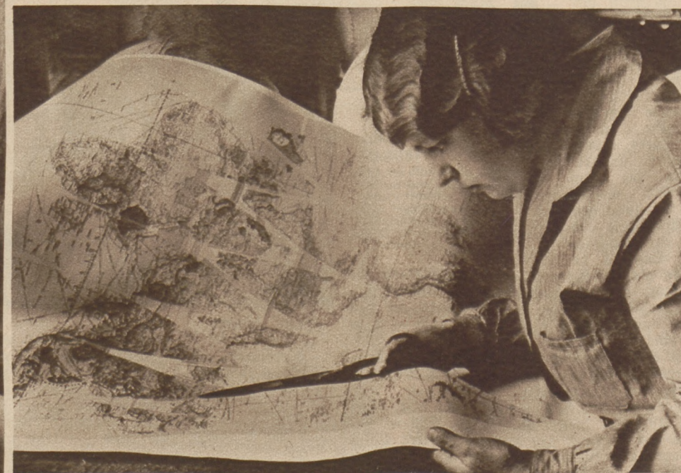
Die lanzettförmig bedruckten (um die Rundung zu erzielen) Kartenblätter werden ausgeschritten.
