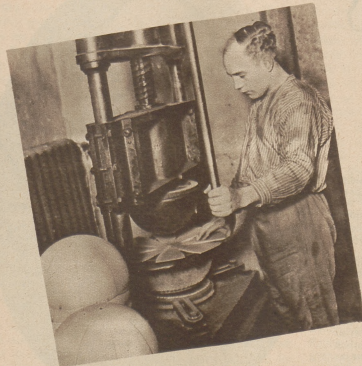
Aus Steinpappscheiben werden durch Pressen Halbkugeln hergestellt.
