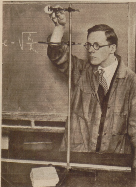
Die „statische“ Prüfung des Golfballes. Sie ähnelt bekannten Metallprüfverfahren.
