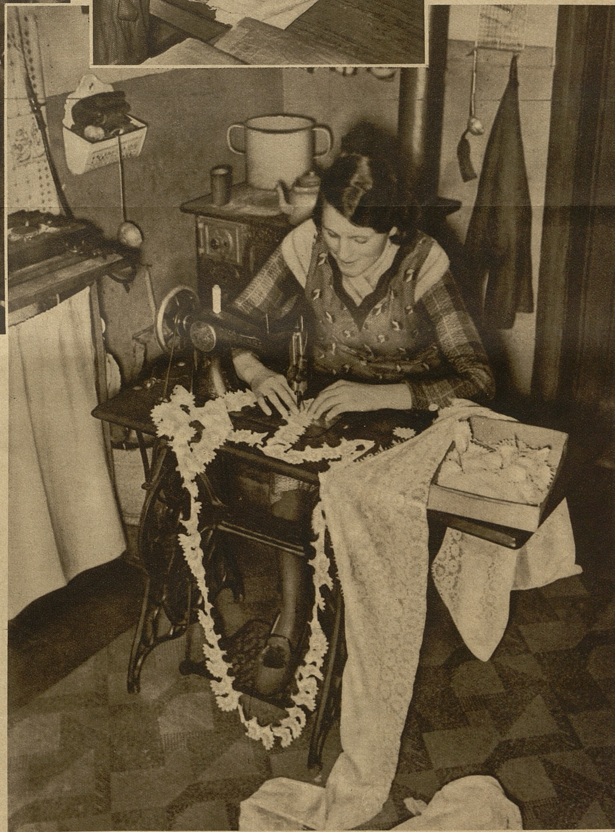
Jetzt wandert die Sticker-Arbeit in die Bleicherei, wo wiederum verschiedene Arbeitsvorgänge auszuführen sind. Nach dem Bleichen werden die „Coupons“ in Folgebüchlein gefächelt, das — wie unser Bild zeigt — nicht maschinell, sondern durch Handarbeit geschieht, da andernfalls die garten Stickeren zu leicht zerstört werden könnten.
