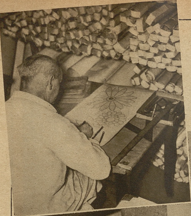
Der Zeichner beim Aufarbeiten einer dreiteiligen Schablone, nach der die einzelnen Sticker die Abzeichen auszuführen haben. Die Schablone ist 6mal so groß wie das Muster.
