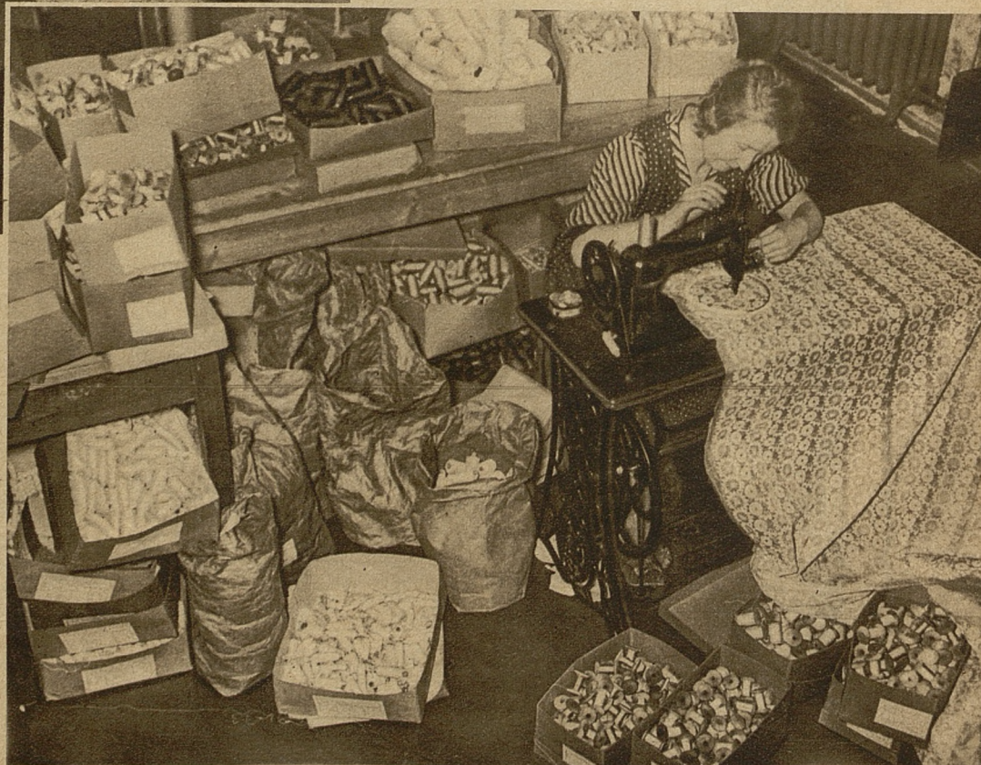
Das Aufpaß-Mädchen an der Sticker-Maschine hat die Aufgabe, während des Ganges der Maschine etwa gerissene Fäden wieder einzufädeln. Jede Sticker-Maschine hat zwei Etagen, die gleichzeitig laufen, wo die Stickerarbeit des Stickers je nach der Länge der Maschine 224 bzw. 448 mal übertragen wird.
