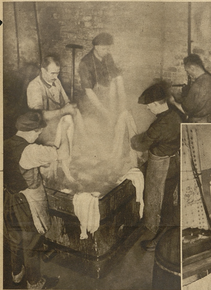
Jetzt wandert die Sticker-Arbeit in die Bleicherei, wo wiederum verschiedene Arbeitsvorgänge auszuführen sind. Nach dem Bleichen werden die „Coupons“ in Folgebüchlein gefächelt, das — wie unser Bild zeigt — nicht maschinell, sondern durch Handarbeit geschieht, da andernfalls die garten Stickeren zu leicht zerstört werden könnten.
