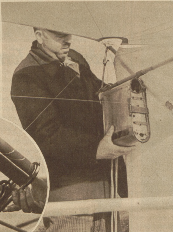
Der Meteorograph wird am Drachen befestigt.
