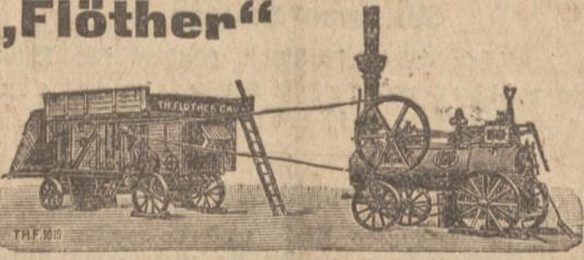
**Dampf- u. Motor-Dreschmaschinen**
