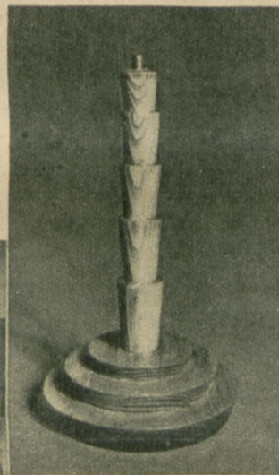
Ein schöner Stehlampen- fuß, an der Drehrolle gedreht (aus der Tischlerei der Jugendlichen)
