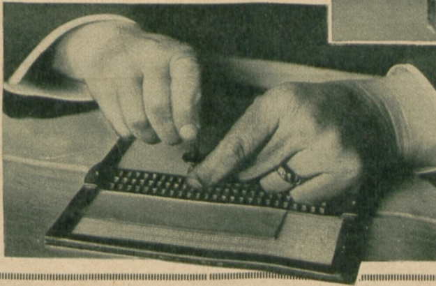
Blinde stanzen nach Diktat mit Hilfe elektrisch betriebener Stanzmaschinen den Text in Blindenschrift in die Zinkplatten ein
