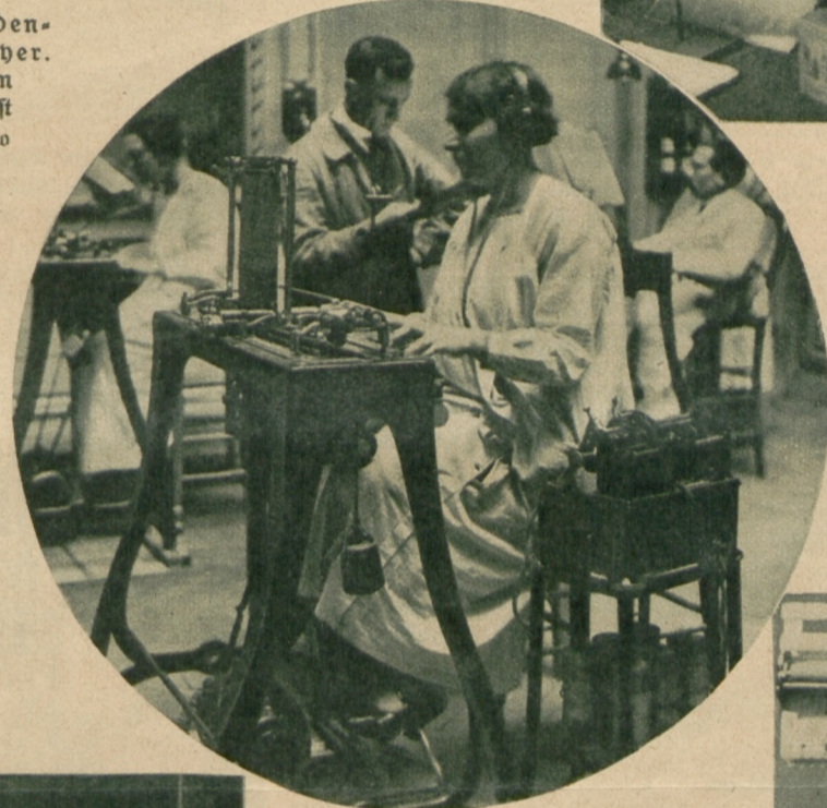
Blinde stanzen nach Diktat mit Hilfe elektrisch betriebener Stanzmaschinen den Text in Blindenschrift in die Zinkplatten ein
