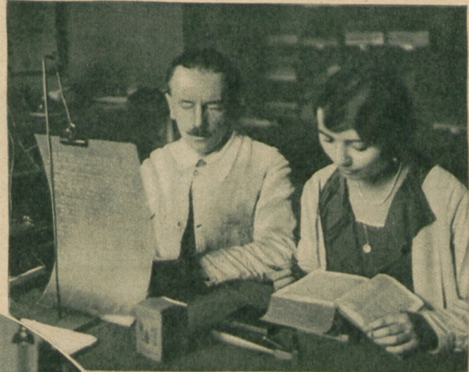
Das Lesen von Korrekturen in der Blindenschrift Herstellung. Ein Blinder tastet die gestanzte Zinkplatte ab und spricht den Text. Auf diese Weise wird er mit dem Text der Druckschrift verglichen
