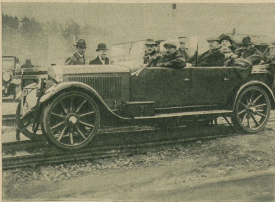
Mit einem Kraftwagen für Schienenbenutzung werden jetzt Versuche seitens der deutschen Reichsbahn angestellt. Die alte „Dräfsine“ in moderner Form. Atlantic
