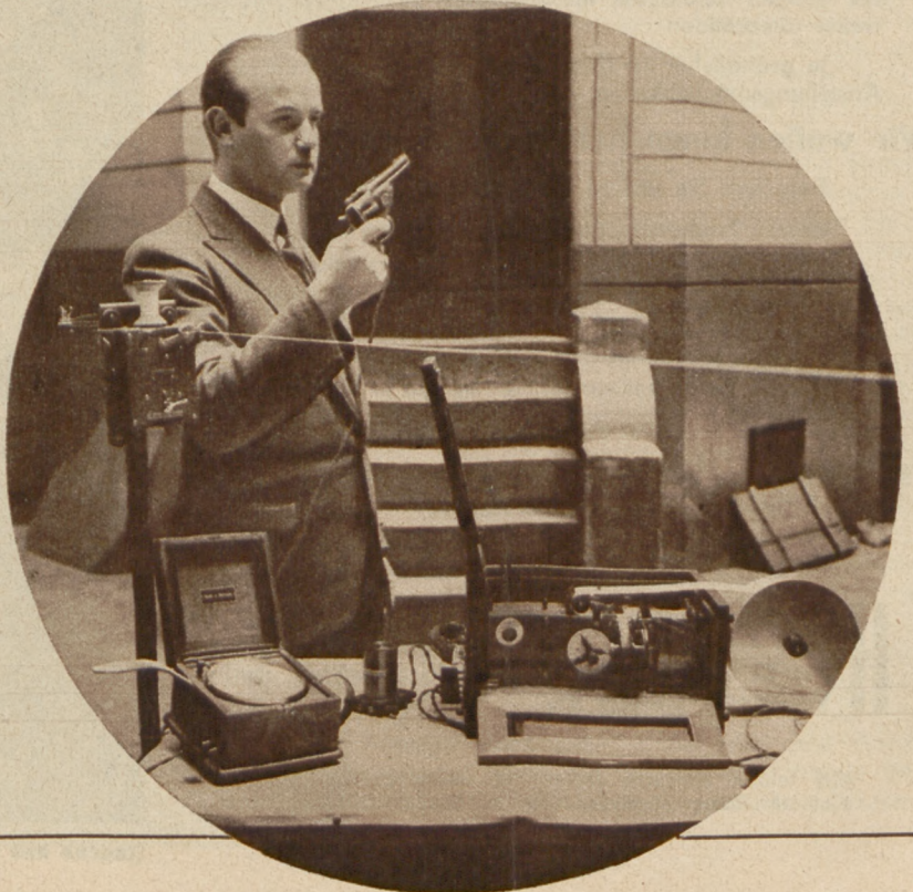
Unten: Neue deutsche Zeitmeßapparate für Los Angeles. Für die kommende Olympiade 1932 in Los Angeles ist von deutschen Ingenieuren ein neuer Zeitmeßapparat konstruiert, der genauer als der beste Zielrichter die erzielten Zeiten der Wettkämpfe aufzeichnen wird. Dieser Zeitmesser wird durch den Startschuß automatisch ausgelöst und durch das Zerreißen des Zielbandes automatisch abgestoppt
