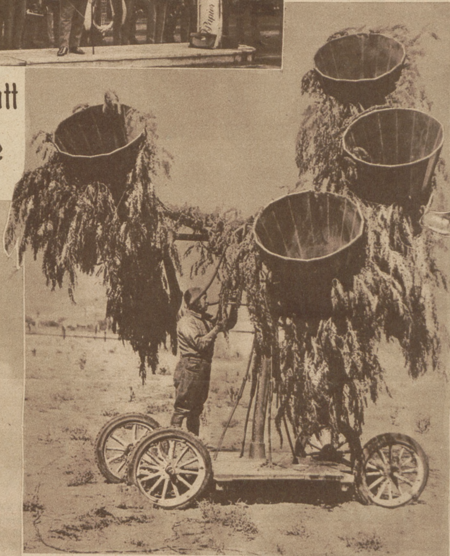
Die Ohren der Armee. Während der kürzlich stattgefundenen Manöver benutzten die amerikanischen Truppen riesige Abhörapparate, mit denen das Herannahen von Flugzeugen auf Meilenweite festgestellt werden kann. Die Apparate sind sorgfältig getarnt E. B. D.
