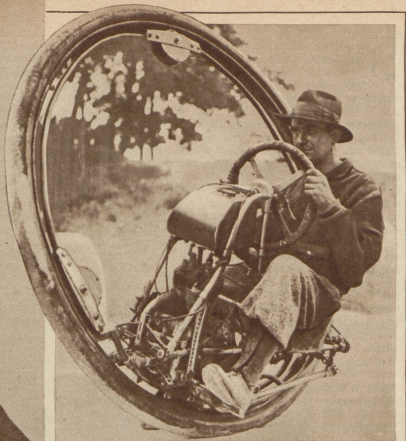
Im Motor-Einrad um die Welt will der Schweizer Erfinder Gerder. Er erreicht 35 Stundenkilometer Geschwindigkeit
