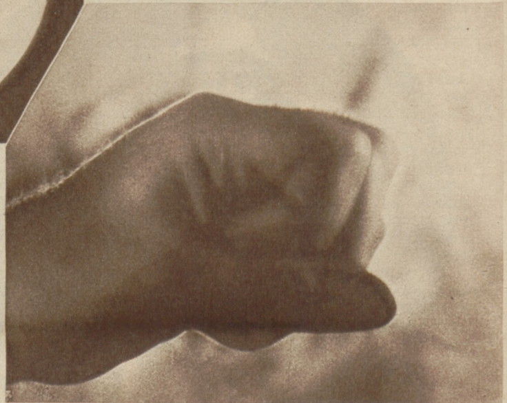
Wärmeschlieren der Hand nennt man die Sichtbarmachung der durch die Blutwärme erzeugten Wallungen der umgebenden Luft
