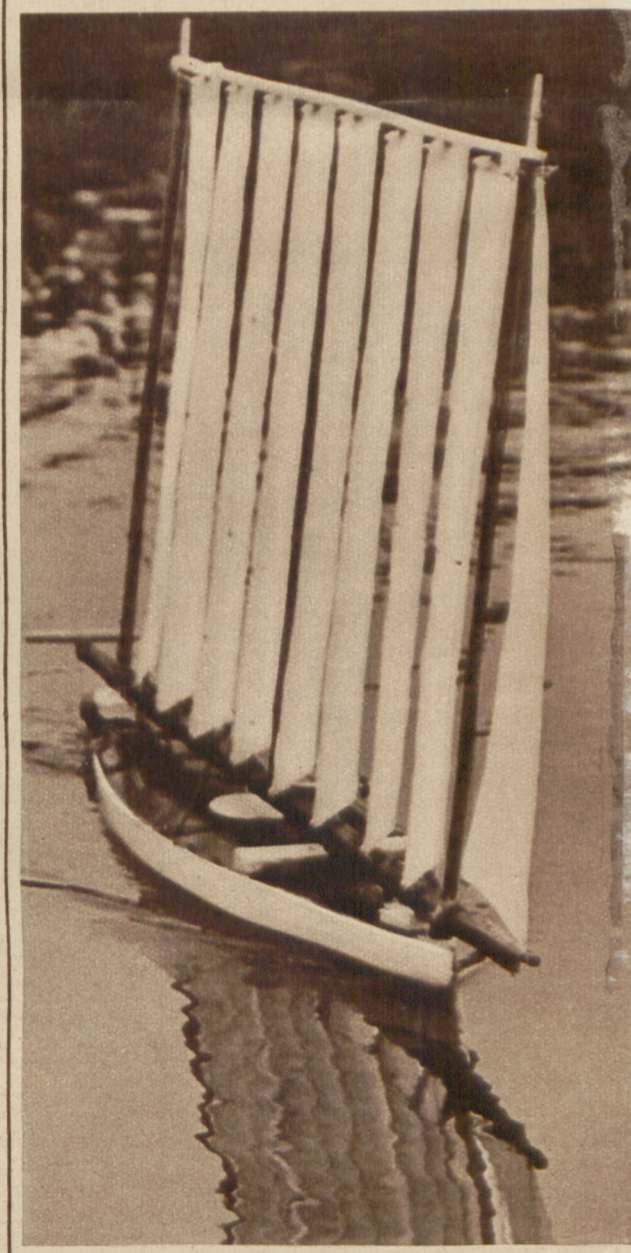
Eine neuartige Yacht wurde auf der Londoner Ingenieur-Modellausstellung gezeigt. Sie ist mit venezianischen Segelblenden ausgestattet, die die Kraft des Windes turbinenartig verwerten. Neben sonstigen Vorteilen soll diese Einrichtung größere Schnelligkeit entwickeln als üblichen Segelboote. — Das 1,25 Meter lange Modellboot in
