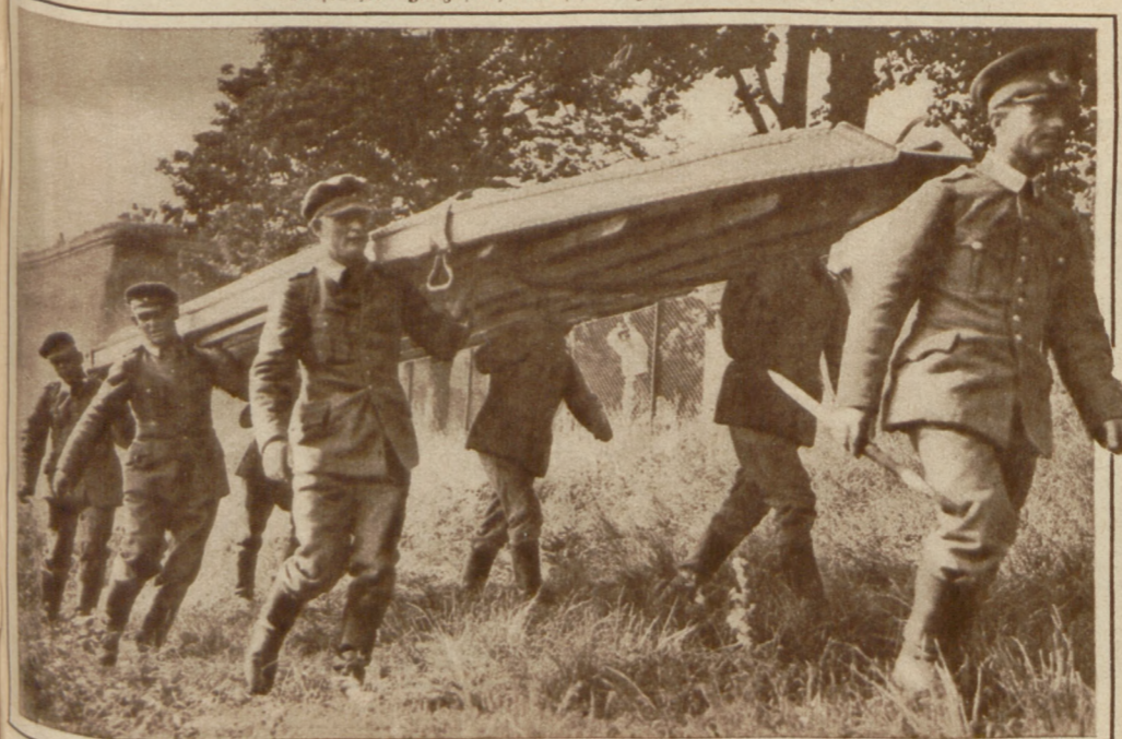
Bild unten: „Pantboote“ aus Stahl. Bei der Vorführung eines Präfekturbaus zeigten Pioniertruppen der deutschen Reichswehr zum ersten Male eine neue Pontonart, Boote aus Stahl, die zum bequemeren Verfrachten ganz flach und schmal zusammenklappbar sind
