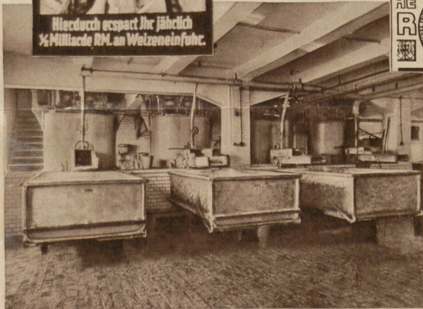
Aus dem Fabrikationsprozeß der trustfreien deutschen Margarine-Industrie. Diese Behälter, auch „Kinnen“ genannt, sind große Butterfässer, in denen die Rohstoffe (Milch, Fettgemische und Eigelb) zu einer cremearartigen Emulsion gerührt und dann durch Tiefkühlung beständig gemacht werden
