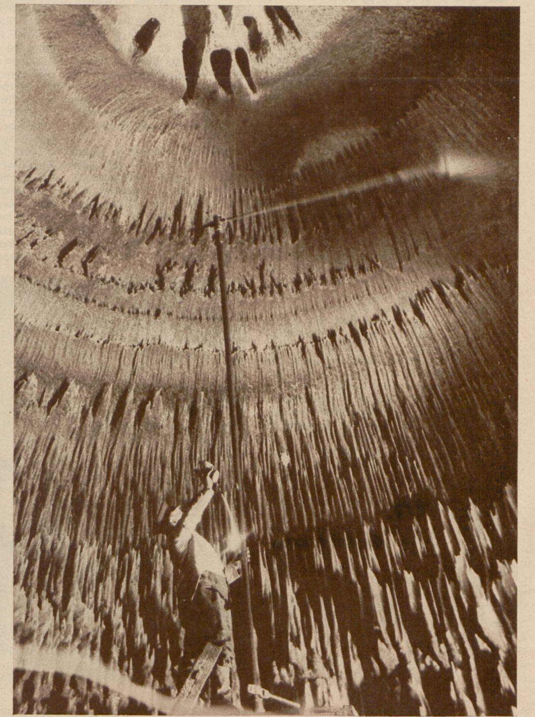
Unten: So wird das Salz gewonnen. In Röhren wird Wasser herbeigeführt, das durch kleine Löcher gegen die Salzwände gespritzt wird. Das Wasser löst dann das Salz auf
