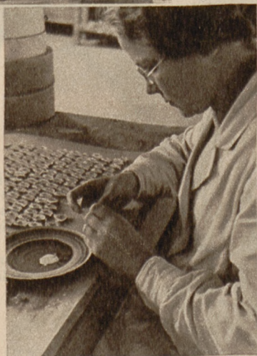
In die sonst fertig-gestellten Abzeichen wird zum Schluß noch eine Nadel zum Anstecken eingestiftet
