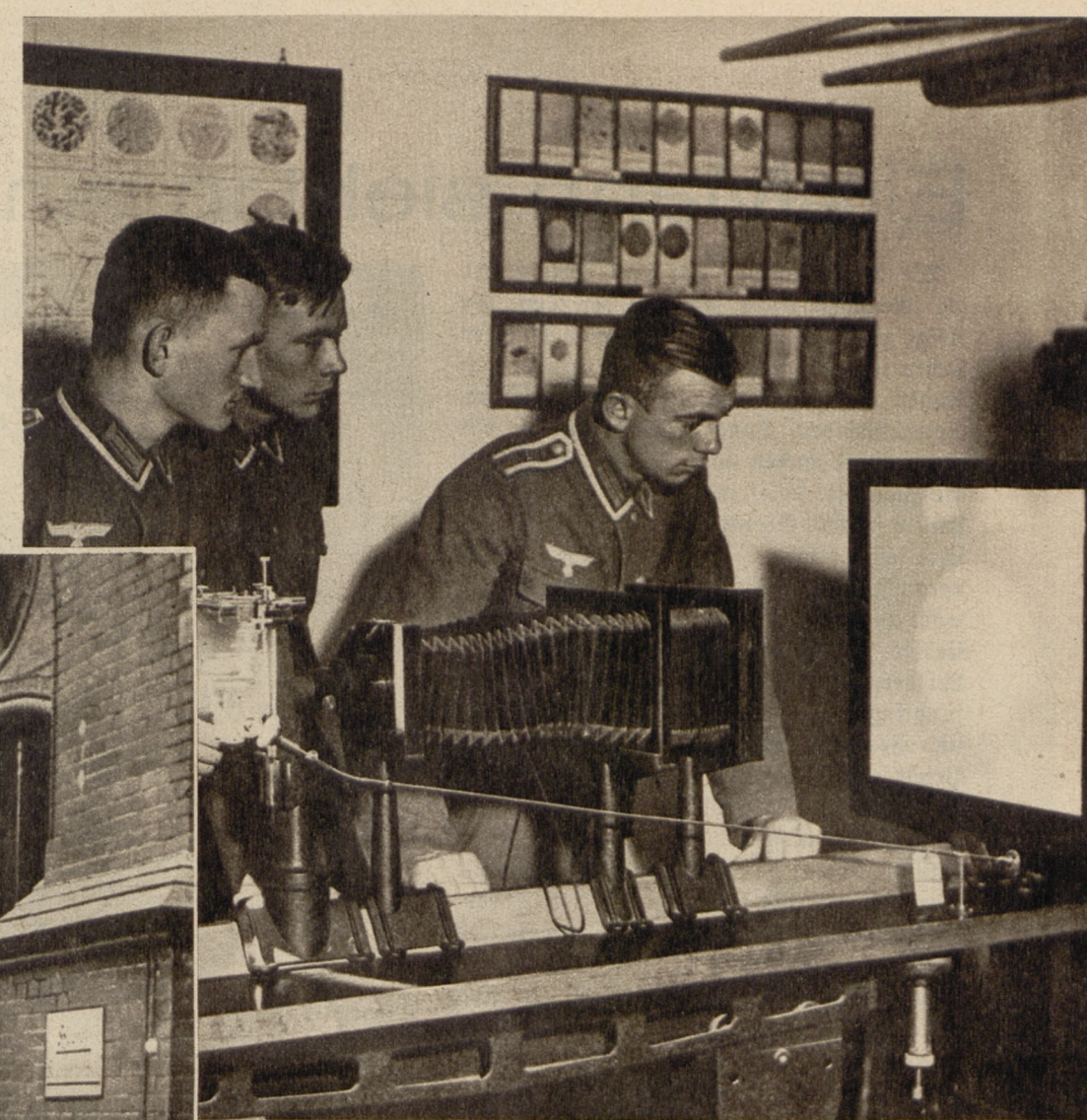
Links: Das Metall-Mikroskop gibt über den Gefüge-Aufbau untersuchter Proben Aufschluß und gestattet auf der optischen Bank eine Demonstration in größerem Maßstabe, indem das Bild auf eine Mattscheibe geworfen wird
