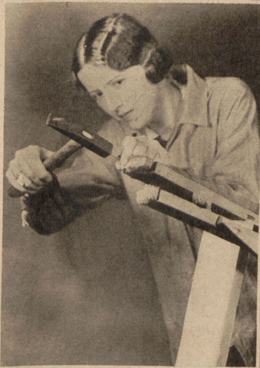
Auf die Füße einer Stehleiter werden Stückchen eines alten Gummischwammes genagelt. Sie ist so gegen jedes Rutschen gesichert
