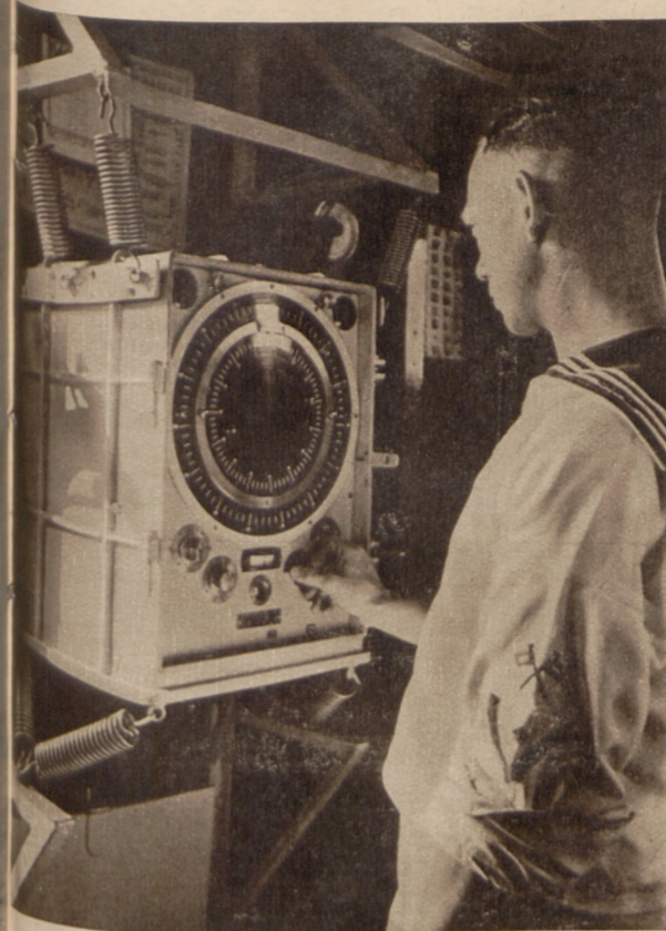
Das Radiolot, ein modernes Hilfsmittel zur Feststellung der Meerestiefe
