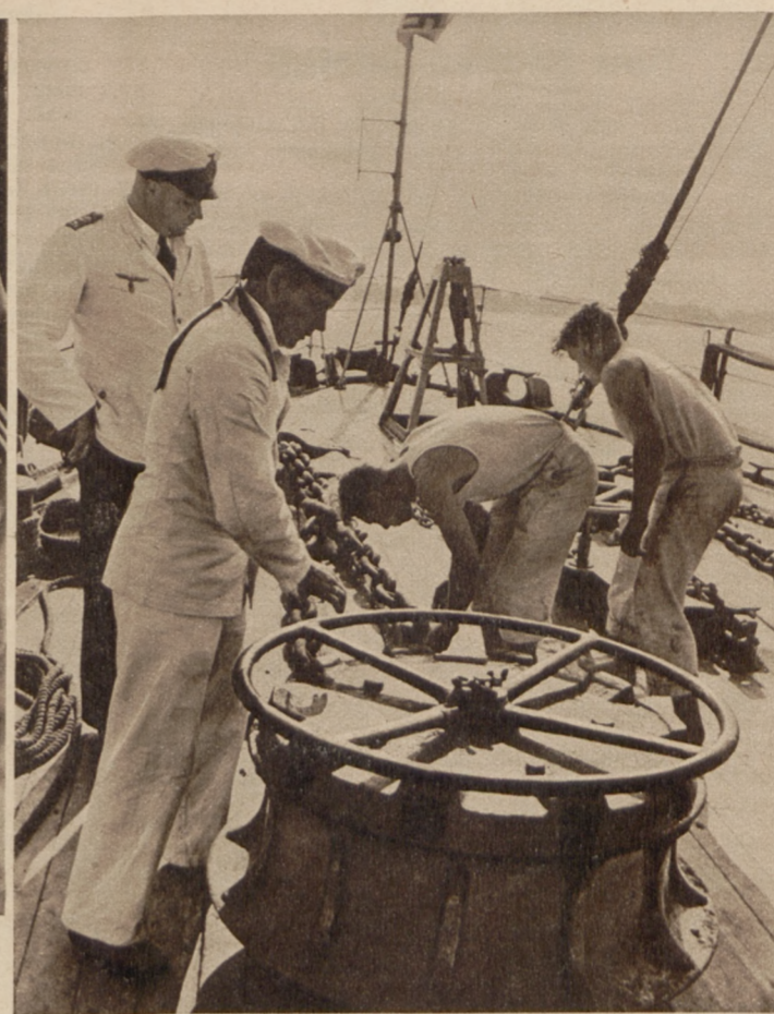
Untermanöver Das Spill zieht den Anker aus dem Grund in die Klüse am Bug, wo er gesichert wird
