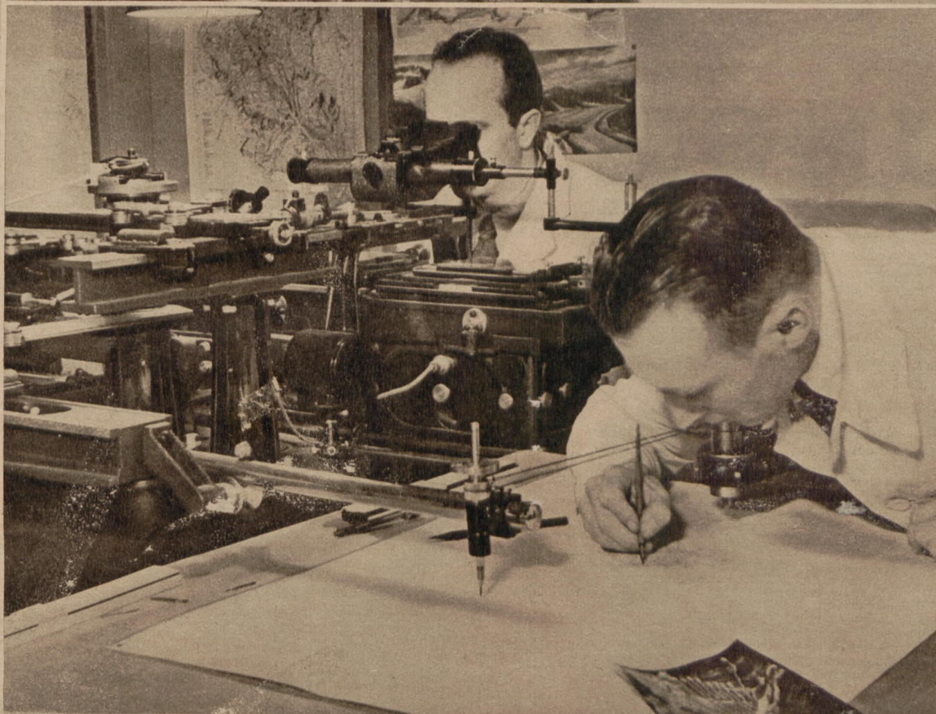
Der Stereo-Autograph mit dem kartographischen Zeichenstift und dem Kartentisch. Nach Beendigung der eigentlichen kartographischen Aufnahme trägt hier einer der wissenschaftlichen Assistenten die kartographischen Zeichnungen wie Maßgebiete usw. in die fertige Karte. Für die Eintragung von Maßgebieten, Flußläufen usw. dient das Photo als Vorlage, in das die Höhenlinien eingezichnet sind.
