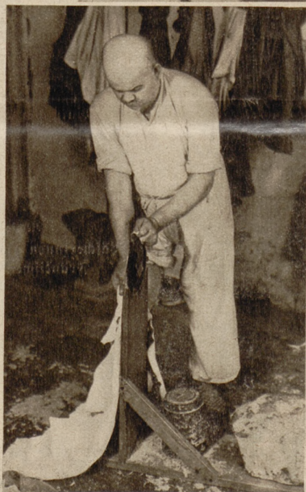
Über den Stollpfahl erfolgt das „Stollen“ oder Zurichten des Leders, um es weich und geschmeidig zu machen
