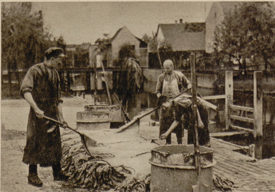
Um die gewaschenen Felle vor Fäulnis zu bewahren, werden sie mit einer Lösung von pflanzlichen und chemischen Stoffen behandelt
