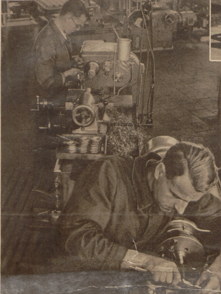
Hier entsteht der Volkswagen Messung eines Werkstücks in der Drehbank
