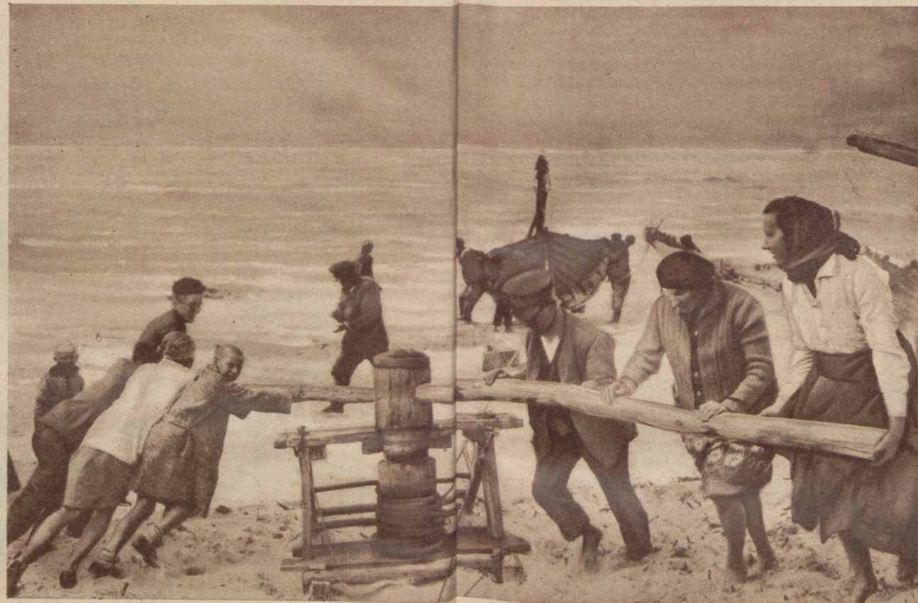
Ein spannender Augenblick ist das Festmachen und Aufwinden der Kutter. Ein Fischerboot wird mittels Winde auf den Strand gezogen
