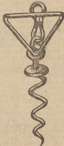
1. Eisenring, um das Aufspalten zu verhüten. 2. Beweglicher Eisenring. 3. Eiserne Spitze.
