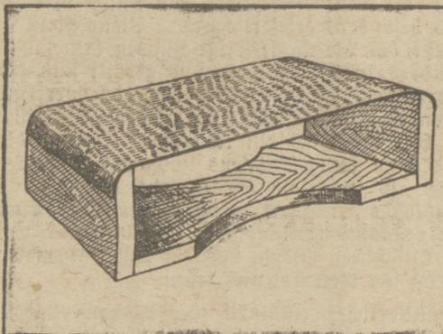
Größe etwa einer Kleiderbürste, vielleicht etwas breiter, wird an den Längsseiten zum bequemeren Ansessen bogenförmig ausgeschnitten. Die Seitenteile messen in der Höhe 8—10 Centimeter. Darüber spannt man recht straff ein Stück Flanell oder Plüsch. Mit dieser Handhabe geht das Nachpolieren rasch und leicht vorstatten.
