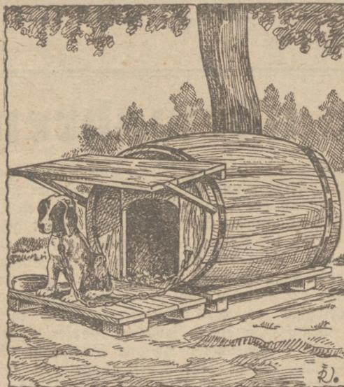
ideale Hundehütte gebaut werden kann. Eine besondere Bauanweisung ist wohl kaum nötig, da die Zeichnung ja alle Einzelheiten deutlich veranschaulicht. Ganz besonders gefällt uns der Vorbau mit dem Schutzdach, da hier der Hund einen stets trockenen und geschützten Ruheplatz findet. In die Hütte kommt als Lager eine gute Schüttung Stroh. Praktisch wäre auch, bei Schneetreiben und Regen den Eingang durch einen Sack vorhang zu schützen. ek.
