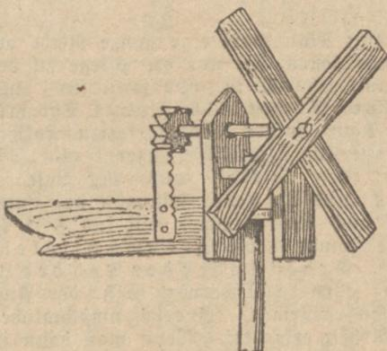
zumachen. Das Rädchen streicht mit den Zähnen über das obere Ende des Sägeblattes und verursacht ein klapperndes Geräusch. Die Ausführung ist an Hand der Abbildung leicht möglich. Die Hauptfahne bleibt die leichte Beweglichkeit der Flügel und die Einstellung nach dem Winde. Deshalb muß die Mühle drehbar auf einer Stange befestigt und mit einem dünnen Brett als Windfahne versehen werden, damit sie sich selbst nach dem Winde dreht. J. Schn.
