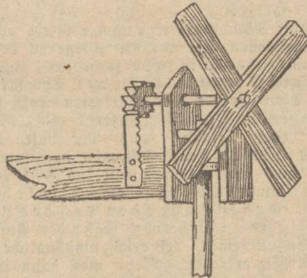
zumachen. Das Rädchen streicht mit den Zähnen über das obere Ende des Sägeblattes und verursacht ein klappendes Geräusch. Die Ausführung ist an Hand der Abbildung leicht möglich. Die Hauptsaite bleibt die leichte Beweglichkeit der Flügel und die Einstellung nach dem Winde. Deshalb muß die Mühle drehbar auf einer Stange befestigt und mit einem dünnen Brett als Windsahne versehen werden, damit sie sich selbst nach dem Winde dreht. J. Schn.
