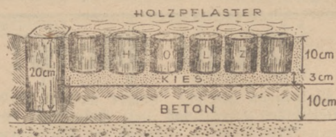
Schema der Holzpflasterung.
