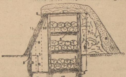
gerüst (4) wird an der Rückseite, von oben und an den beiden Schmalseiten mit billigen Schalbrettern (1) bekleidet. Das Dach steht 20–30 Centimeter vor und trägt ein Stirn Brett (2). Die Borderyposten tragen unter dem Dach ein 16 Centimeter breites Stützbrett (10) für die abnehmbare Bordewand. Der Gang wird mit kurzen Pfählen
