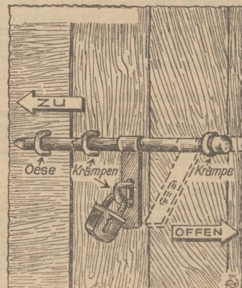
Ein etwa 40 Centimeter langes Stück Gasrohr wird an einem Ende spitz zusammengeschmiedet. An dem andern Ende wird ein Überwurf aus Flacheisen angegeschweißt. Durch zwei Krämpe erhält der Verschluß die Führung. Im geschlossenen Zustande greift der Verschluß in eine am Torrahmen angebrachte Oese. Der Überwurf greift mit seiner Aussparung über eine dritte, in das Tor eingeschlagene Krampe, durch die dann das Vorhängeschloß gezogen wird. Alles einfach, aber zweckmäßig! R., Sch.
