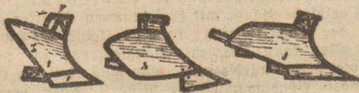
leichter Boden I = Streichblech, II = die Schar, III = Sohle, IV = Griesssäule.
