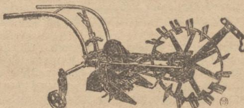
durch Kette auf den eigentlichen Fräsanapparat übertragen, wobei durch ein kleineres Bahnrad die Umgangsgeschwindigkeit erhöht wird. Die Welle des Fräsanapparates muß also eine beschleunigte rotierende Bewegung machen. Die Welle ist mit vielen kleinen Zinken besetzt, die in finger-
