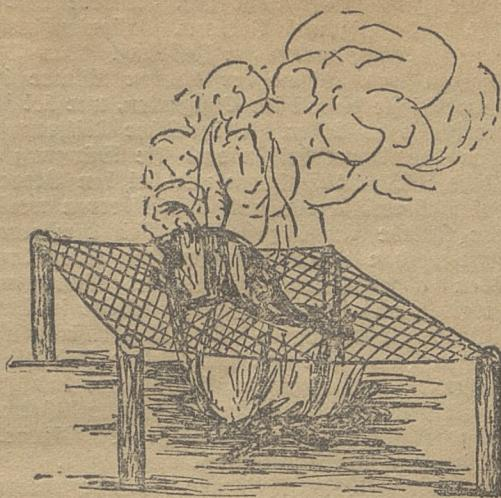
zu erzielen, bediene man sich folgender Vorrichtung (s. Abb.). Vier kleine Pfähle werden im Quadrat in die Erde geschlagen und darüber ein altes, aber starkes Drahtgeflecht gespannt, ungefähr 30 Centimeter über dem Erdboden. Unter diesem Apparat legt man ein starkes Feuer an, welches den oder die auf das Drahtgeflecht gelegten Kadaver vollständig vernichten wird.
