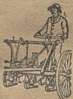
Die Messer der „Harder“ Hackmaschine bleiben stets parallel zum Boden, wodurch ihre günstige Arbeitsweise erzielt wird. Sie erhalten diese Stellung durch Verriegelung des Hackrahmens in der Horizontallage mittels einer überaus sinnreichen Kniehebel-Konstruktion.
