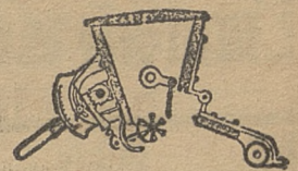
Maschine zwecks Reinigung und Entleerung geöffnet.
