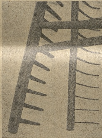
Abb. 7 b. Rechts: Rechen, alles aus Stahl, Links: Holzrechen.
