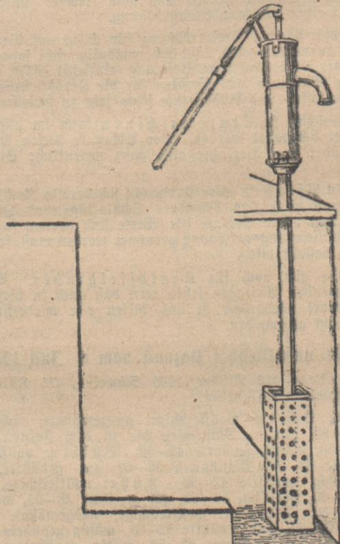
mit ins Pumpenrohr gelangt und Verstopfungen verursacht, wird der untere Teil des Rohres mit einem durchlöcherten Holzlasten umhüllt, so daß der Sidersaft in den Holzlasten treten kann, das Futter aber zurückgehalten wird. Unsere Zeichnung veranschaulicht dies näher.
