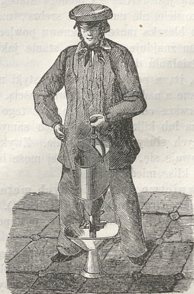
Fig. 13. Siewnik Le Docta w ręku Siewacza. Praktyczne ujęcie i użycie Siewnika pokazuje Fig. 13.
