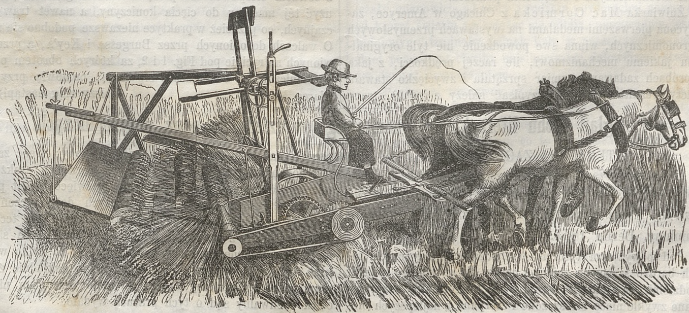
Fig. 1. Żniwiarka Mac-Cormicka z walcami Burgessa i Key'a.
