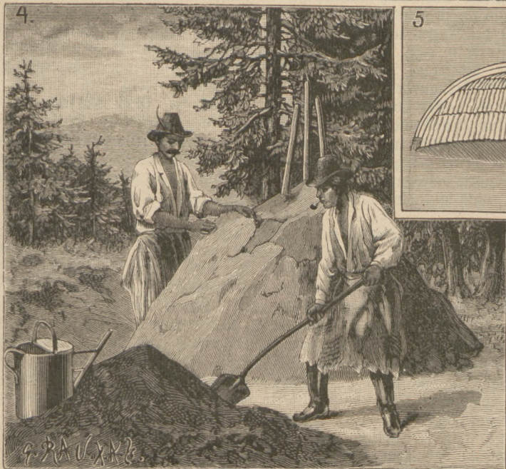
1. Das Herrichten der Kohlplatte. 2. Das Nichten des Meilers. 3. Fertige Meiler nebst Köhlerhütte. 4. Anbringen der feuerfesten Ded. 5. Durchschnitt durch den fertigen Meiler. 6. Das Ausziehen der Kohlen.
