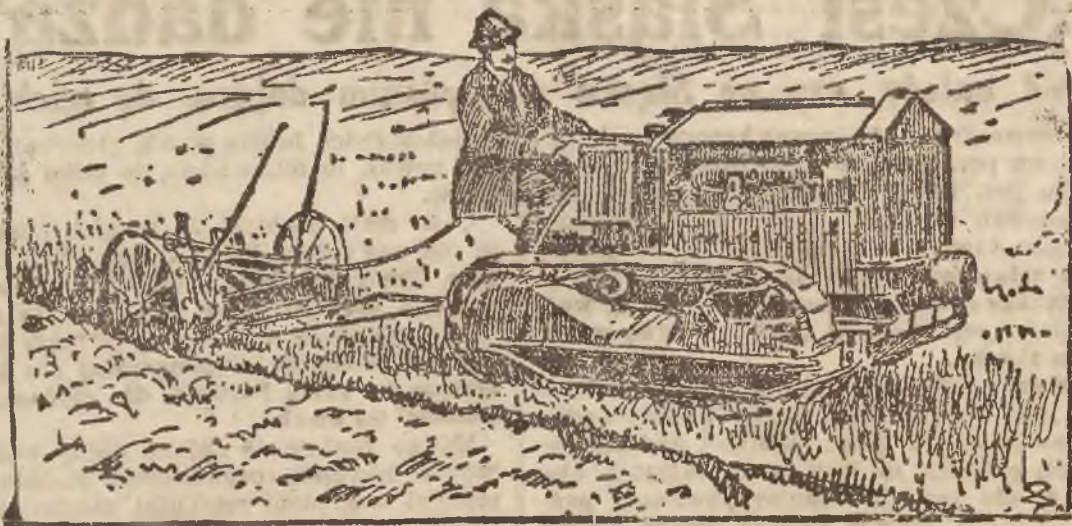
Jak doniosły dzienniki angielskie, słynne tanki czyli czołgi znalazły zastosowanie w rolnictwie. Rycina nasza przedstawia pług motorowy, poruszany przy pomocy mechanizmu, używanego w konstrukcji czołgów.
