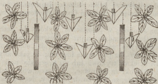
Fig. 6. Rozstawienie trójkątych lemieszów przy użyciu Kultywatora, jako wypielacz do buraków, przy odległości rzędów na 20 cali.
