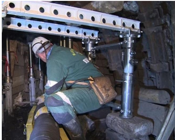
Rys. 9. Obudowa ratownicza HOR-01 w chodniku badawczym [8]
