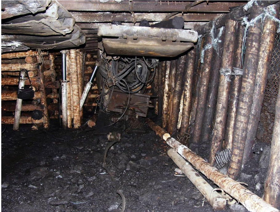
Rys. 4. „Seksja asekuracyjna” usytuowana wzdłuż likwidowanej ściany [10]
