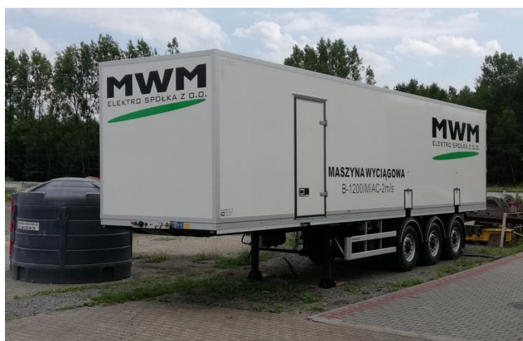
Rys. 1. Kontenerowa platforma transportowa maszyny wyciągowej B-1200/M/AC-2m/s [6]
