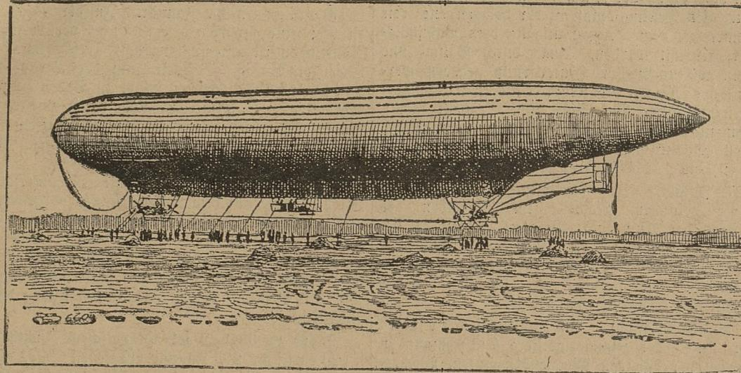
Nach jahrelangem Bau konnte nunmehr der neue große Lenkballon der Siemens-Schuckert-Werke seine drehbare Halle verlassen, um seinen ersten Aufstieg glücklich zu vollbringen. Das Luftschiff hat eine Länge von 118 Metern und besitzt 3 Gondeln, deren vordere und hintere mit je drei Propellern ausgerüstet sind, während die mittlere als Führergondel dient. Bei einem Durchmesser von 13½ Meter faszt das Luftschiff 13 000 Kubikmeter Gas.
