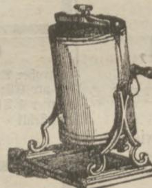
Diese Maschine liefert in 10 bis 15 Minuten 4 Sorten Gefrorene durch Anwendung von
